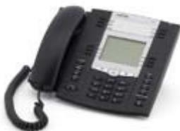
Telefono IP a standard SIP, dotato di display a 8 righe, 4 tasti di linea, 4 tasti di navigazione interattiva con il display, 6 tasti configurabili e dinamici, 6 tasti funzione con LED, 8 tasti funzione predefiniti, 1 LED per Message waiting; connettore per ingresso cuffia, viva-voce, doppia connessione ethernet 10/100 Mb, compatibile IEEE 802.3af inline power. Alimentatore 220 v incluso.
